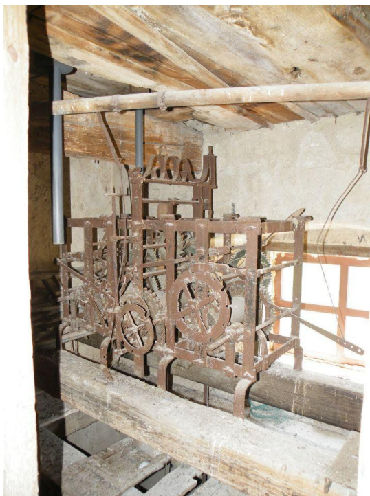
Az 1841-ben készült toronyóra-szerkezet felújítás előtt még a toronyban...
